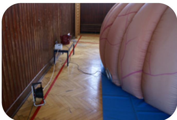
Pravilno nameščen ventilator, ki je v pokončnem položaju. Razdalja do stene je dovolj velika, priključki in kabli so nameščeni skladno s pravili varnosti in zdravja pri delu.
